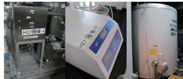
▲気泡式洗米機・洗米機SK-150V ▲分析システム ▲冷却タンク
