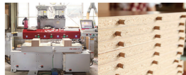
▲PNC 片面ポーリング・ダボ打ち機 ▲正確に打たれたダボ
