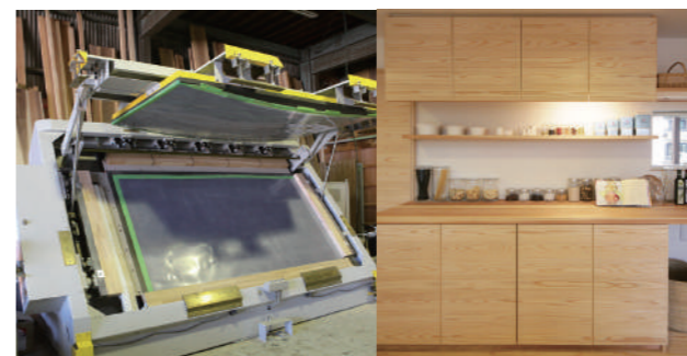
▲高周波板はぎ・枠組み・縁貼り接着機 ▲木材家具の取り付け例
