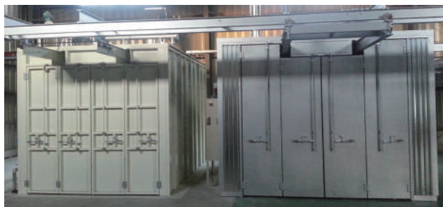
【図1】今回導入した焼付炉・搬送設備
