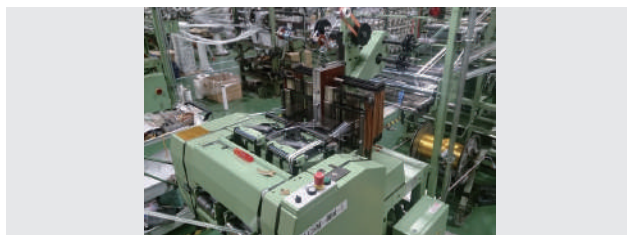
【図1】ヤコブミュラー社製 厚物ベルト用高速ニードル織機（型番NC2-2/130GG）
