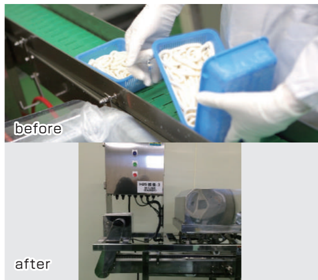
【図2】「脱パン装置(反転装置付き)」の導入により、異物混入等のリスクが軽減された。
