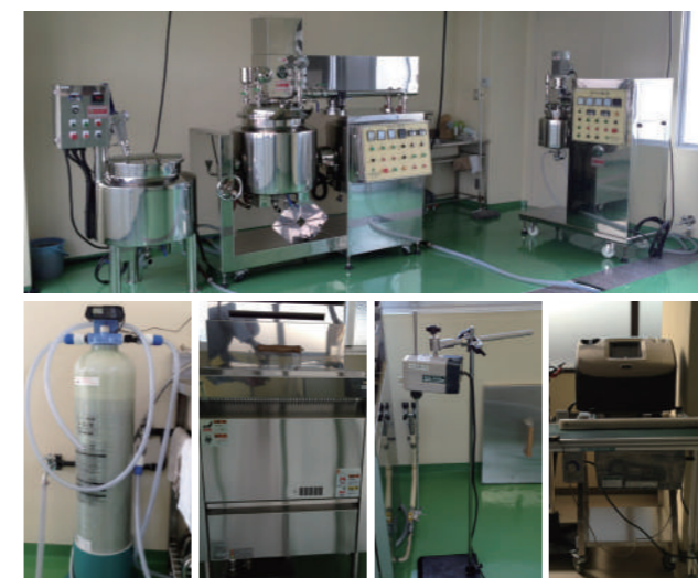
▲真空乳化装置・周辺機器設置
