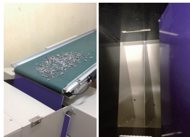
【図1】ベルトコンベアでの投入の様子【図2】シュート板と仕切り板の関係
