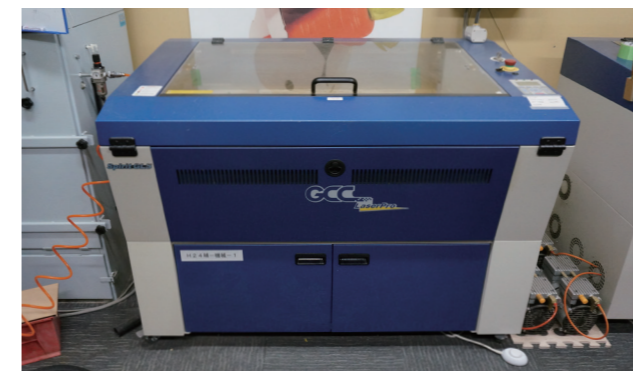
【図2】レーザー加工機の設置
