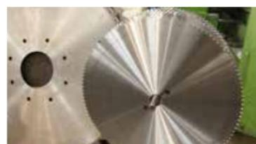
導入機器により本事業の騒音低減対策である「チップソー刃の不等間隔ピッチ配列」と「チップソーの刃先の負荷を分散させる分割形状刃型」を組み合わせた低騒音対策チップソーを短時間で製作でき、研磨精度も高精度を保ちながらも、生産効率が大幅に向上した。またデジタルマイクロスコープの導入により、検査測定時間も大幅に短縮できた。アルミ製品市場において今後もニーズが予想され売上向上も見込まれる。
